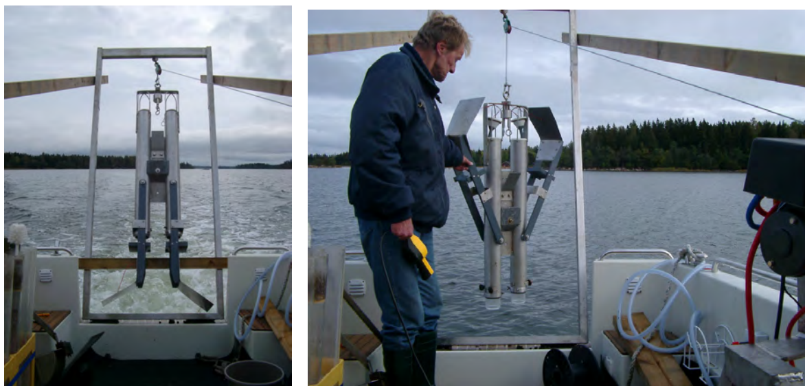
Figur 5 Vänstra bilden: Gemini-hämtaren surrad för transport. Högra bilden: Geminihämtaren laddad och redo för hugg.
