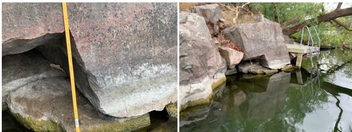
Figur 3. Vattenståndet mättes den 16 augusti 2021 till 57 cm under den räta inskärningen i stenblocket vid Brantstigen i södra delen av Norrviken.
