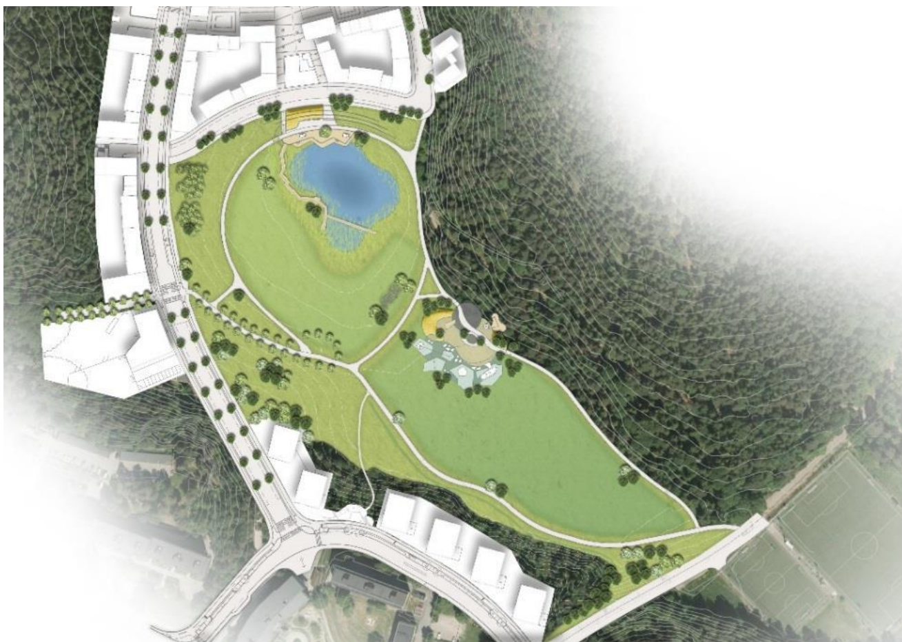
Figur 15. Föreslagen placering och utformning av dagvattendammen i Sportfältsparken (Blomér, 2017).
