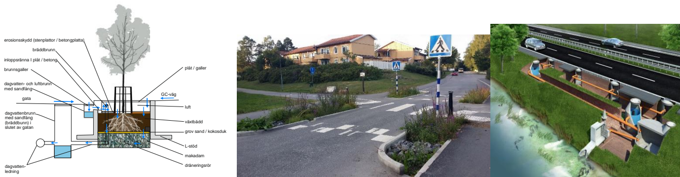
Figur 10. Växtbäddar och avancerade brunnsfilter som förslag på eventuella nya lösningar för behandling av vägdagvattnet från Frestavägen.
