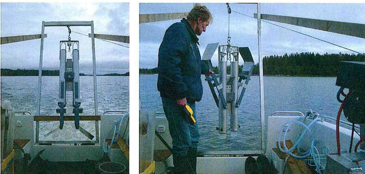
Figur 7. Vänstra bilden: Gemini-hämtaren surrad för transport. Högra bilden: Gemini-hämtaren laddad och redo för hugg.
