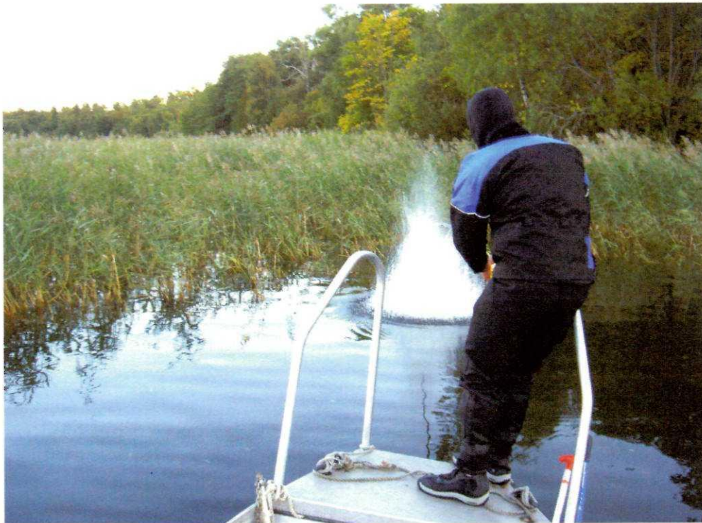
Foto 1. Sprängfiske m h a metspö, sprängkapsel/sprängmedel, non-el tändtråd och elektrisk tändapparat. Här ses en detonation vid Lokal 6, Edsviken. Foto: Anna Skarp.
