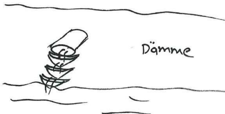
Figur 24. Skissen visar hur en fisktrappa kan kombineras med ett rör som går genom bäverdämmet och på så sätt reglerar vattennivån.
